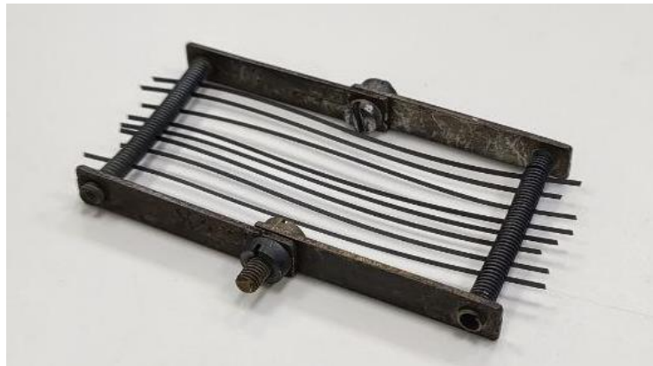
Рисунок 2.5 – Фотография пружинной рамки, предназначенной для индивидуального старения пленочных образцов.
