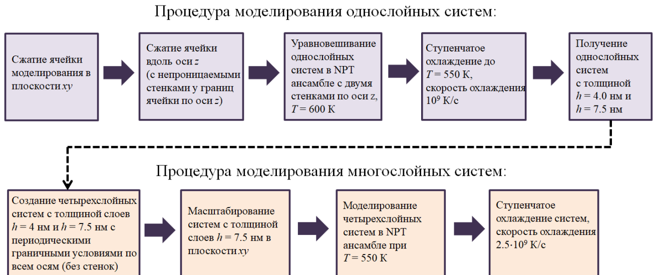
Рисунок 2.3 – Схематическое описание основных этапов процедуры моделирования для однослойных систем и впоследствии для многослойных систем, созданных на основе однослойных
