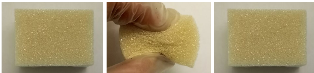
Рисунок 63 – Восстановление формы образца ППИ ДФО-ДАДФЭ-ГМДА (30 %) через 5 мин после снятия нагрузки
