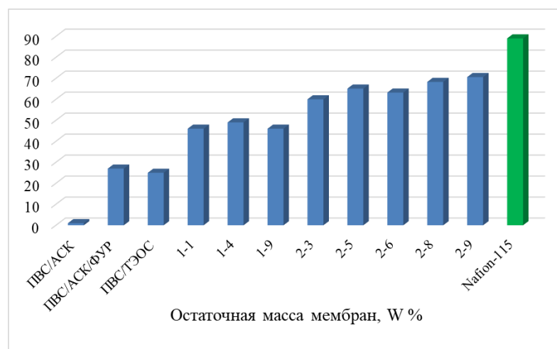
Рисунок 3.22 – Остаточная масса ряда полученных мембран двух Латинских квадратов и эталонной мембраны Nafion-115 после их нахождения в реагенте Фентона в течение 24 часов
