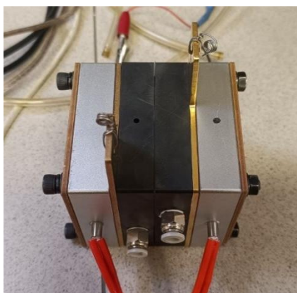
Рисунок 2.8 – Внешний вид измерительной ячейки для МЭБ площадью 7.84 см 2
