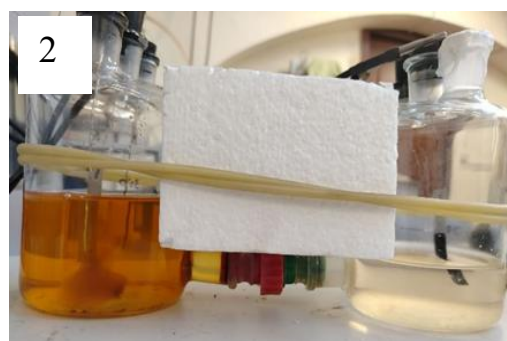
Рисунок 5.4 – Выработка электроэнергии (среднее значение тока за сутки) двух МТЭ-1 с мембранами: а) NaFion-115, б) гибридной 2-9, вставка – фотографии МТЭ-1 с 2-9 до – 1 и после – 2 эксперимента
