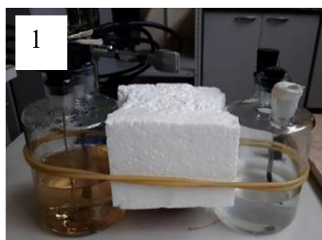
Рисунок 5.4 – Выработка электроэнергии (среднее значение тока за сутки) двух МТЭ-1 с мембранами: а) NaFion-115, б) гибридной 2-9, вставка – фотографии МТЭ-1 с 2-9 до – 1 и после – 2 эксперимента
