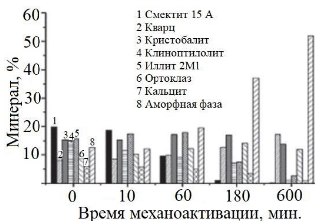
Рисунок 1.3 – Влияние времени механической активации на фазовый состав цеолитовой породы [113]
