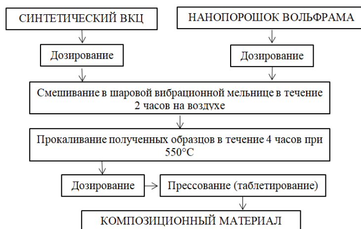
Рисунок 1.12 – Технологическая схема получения композиционных материалов на основе синтетического высококремнеземного цеолита и нанопорошка вольфрама (составлено автором на основе работы [148])
