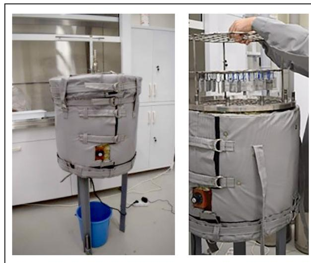
Рис. 2. Внешний вид установки для коррозионных испытаний
