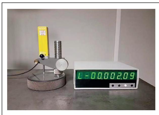
**Рис. 2.** Дальномер голографический ДГ-30 с выходом на автономный блок индикации
