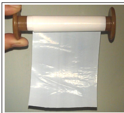
Пористая пленка поливинилиденфторида, используемая в качестве сепаратора для литиевых источников тока
