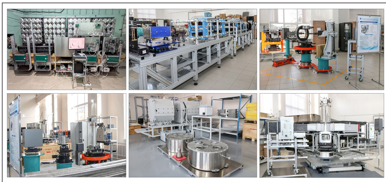
Нейтронные станции после предварительной сборки. Верхний ряд (слева направо): приборный комплекс «Нейтрино»; установка спин-эхо ультрамалоуглового рассеяния нейтронов SESANS; четырехкружный дифрактометр DC1. Нижний ряд (слева направо): трехосный спектрометр холодных нейтронов IN2; установка исследования множественности осколков деления FISCO; порошковый многодетекторный дифрактометр тепловых нейтронов D3
