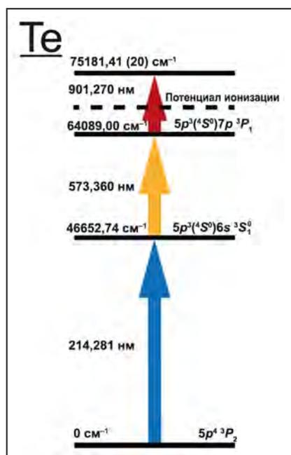
Рис. 1. Оптимальная схема резонансной ионизации теллура через автоионизационное состояние
