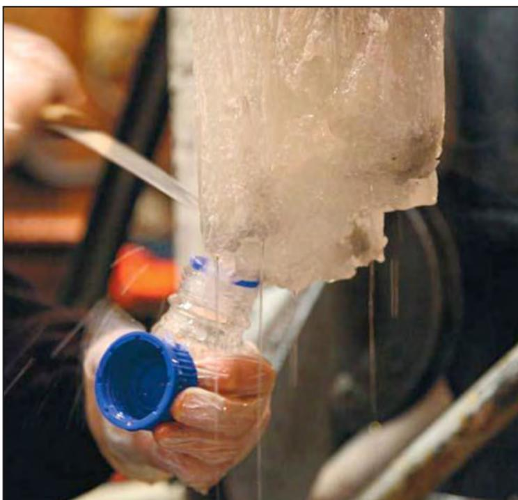
Отбор материала из замерзшей “drill-bit” воды на буровой коронке. Отчетливо видны струйки стекающей буровой жидкости
