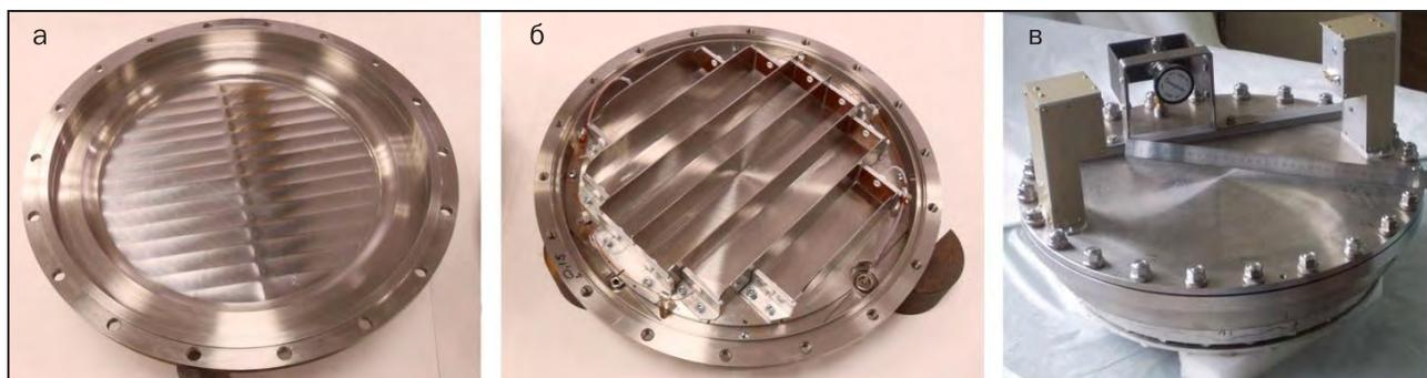
Части детектора УХН: верхняя крышка с входным окном, виден профиль поддерживающей решетки после испытаний номинальным давлением (а); нижняя часть детектора (основание) с шестью пропорциональными счетчиками (б); собранный детектор, вид со стороны основания, видны два предусилителя и газовый вентиль (в)
