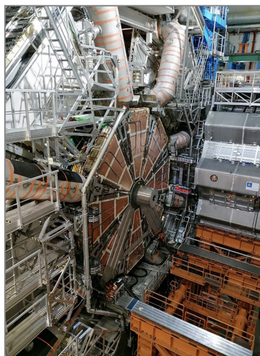
Новое малое мюонное колесо типа А в шахте эксперимента ATLAS
