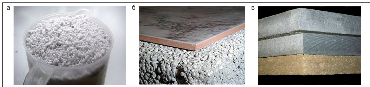
Вспученный перлит (а); перлитобетон (б); пеноперлит (в)
