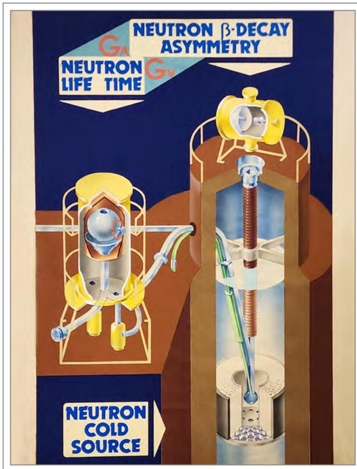
Схема универсального канала поляризованных холодных и ультрахолодных нейтронов с жидководородным источником в центре активной зоны реактора. Комплекс установок для измерения времени жизни нейтрона и асимметрии распада нейтрона
