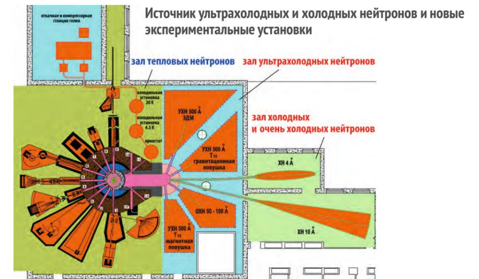
Уникальность проекта источника ультрахолодных нейтронов на реакторе ВВР-М заключается в использовании сверхтекучего гелия, что позволит достичь плотности ультрахолодных нейтронов, которая примерно в 1 000 раз превысит плотность ультрахолодных нейтронов на существующих в мире источниках.
